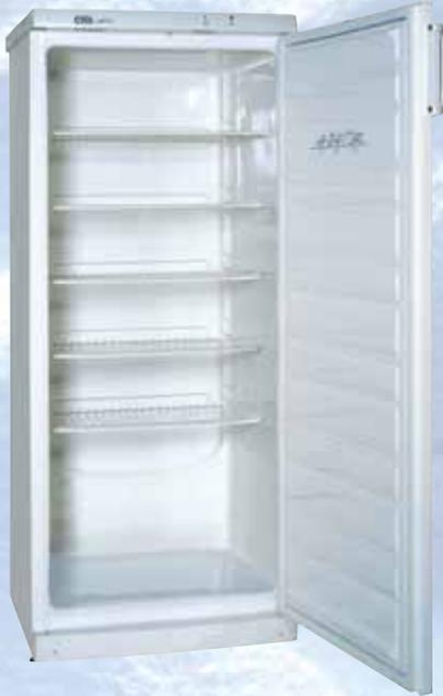
→ **C 290**, steckerfertiger **Gewerbekühlschrank** mit Volltür; stille Kühlung; Innenbeleuchtung; Türanschlag wechselbar; automatische Abtauung; 2 Rollen hinten, 2 justierbare Stellfüße vorne; BxTxH in mm: 600 x 600 x 1450; Bruttoinhalt: 290 l; Temperaturbereich: 0 °C bis +10 °C bei +32 °C Umgebungstemperatur; Anschlusswert: 150 W/ 230 V.
