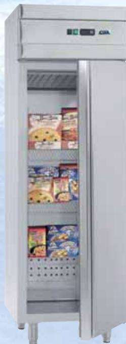
**KU 400 CNS**, steckerfertiger **Umluft-Gewerbekühlschrank**; einfache Reinigung durch herausnehmbare Führungsschienen und Tragroste (3 Stück im Lieferumfang enthalten); BxTxH in mm: 600 x 600 x 1885; Temperaturbereich: +2 °C bis +8 °C bei +43 °C UT; Anschlusswert: 232 W/ 230 V.
