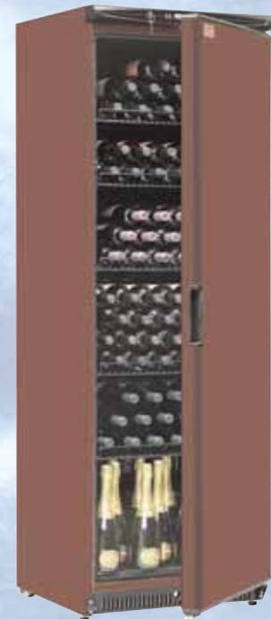
**VISION 40,** doppelt isolierte Glasür mit UV-Filter, UV-gefilterte Innenbeleuchtung; schwarzer Türrahmen, Türanschlag wechselbar; BxTxH in mm: 600 x 635 x 1865; Klimaklasse 4 (+30 °C UT, 55% RF); Anschlusswert: 280 W/ 230 V.
