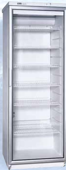
**CD 350**, steckerfertiger Umluft-Gewerbekühlschrank mit Glastür im Alu-Rahmen; Türanschlag wechselbar; Innenbeleuchtung; automatische Abtauung; BxTxH in mm: 600 x 600 x 1730; Bruttoinhalt: 350 l; Temperaturbereich: +2 °C bis +12 °C bei +32 °C UT; Anschlusswert: 230 W/ 230 V.
