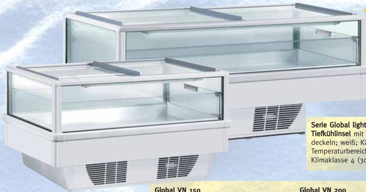
**Serie Global light**, steckerfertige Tiefkühlinsel mit zwei Glasschiebedeckeln; weiß; Kältemittel R 507; Temperaturbereich: -18 °C bis -25 °C; Klimaklasse 4 (30 °C UT, 55 % RF).
