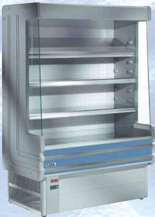
Steckerfertiges **Wandkühlregal** mit Umluftkühlung; automatische Abtauung mit Tauwasserverdunstung; Frontdekor blau marmoriert; Beleuchtung, graue Seitenteile aus stoßfestem ABS-Kunststoff; Temperaturbereich: +3 °C bis +6 °C bei +30 °C UT und 60 % RF.
