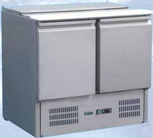
**SL 9-II**, steckerfertige **Saladette** mit Umluftkühlung für GN 1/1; komplett aus CNS DIN 1.4301; auf drei Seiten eingeschäumter Verdampfer; abgerundeter Boden; Teleskop-Schiebedeckel; automatische Abtauung; elektronische Digitalkontrolle; Türen mit Magnetsichtung; zwei Tragroste und zwei Paar Auflageschienen; Schneidbrett aus Polyäthylen; BxTxH in mm: 900 x 700 x 850; Bruttoinhalt: 270 l; Temperaturbereich: 0 °C bis +10 °C bei +30 °C UT und 55% RF; Anschlusswert: 180 W/ 230 V.
