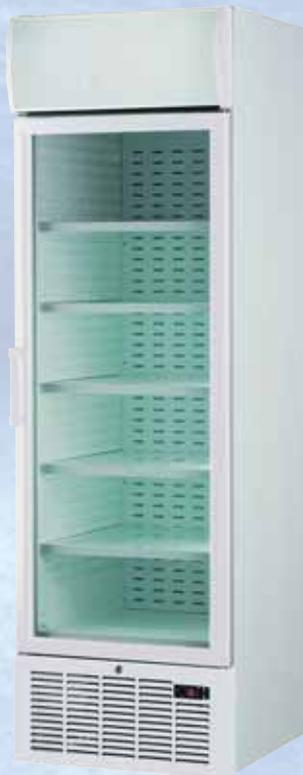
**HG 500 GP**, steckerfertiger Umluft-Gewerbekühlschrank mit beleuchtetem Werbedisplay und Schloss; BxTxH in mm: 595 x 750 x 1980; Nettoinhalt: 320 l; Fassungsvermögen 0,5 l-Flaschen: 200; Anschlusswert: 345 W/ 230 V. Art.-Nr.: **466.105.00**
