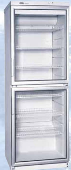
**CD 350-2**, steckerfertiger Umluft-Gewerbekühlschrank mit zwei Glastüren im Alu-Rahmen; Türanschlag wechselbar; Innenbeleuchtung; automatische Abtauung; BxTxH in mm: 600 x 600 x 1730; Bruttoinhalt: 350 l; Temperaturbereich: +2 °C bis +12 °C bei +32 °C UT; Anschlusswert: 230 W/ 230 V.
